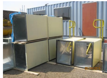
Ductos encaquetados, interior FeGo y exterior en FeNo, aislante lana de vidrio, acabado pintura epóxica para Sala Eléctrica de Cía Minera Cerro Verde.
