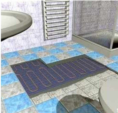
SISTEMA DE CALEFACCION POR LOSA RADIANTE
